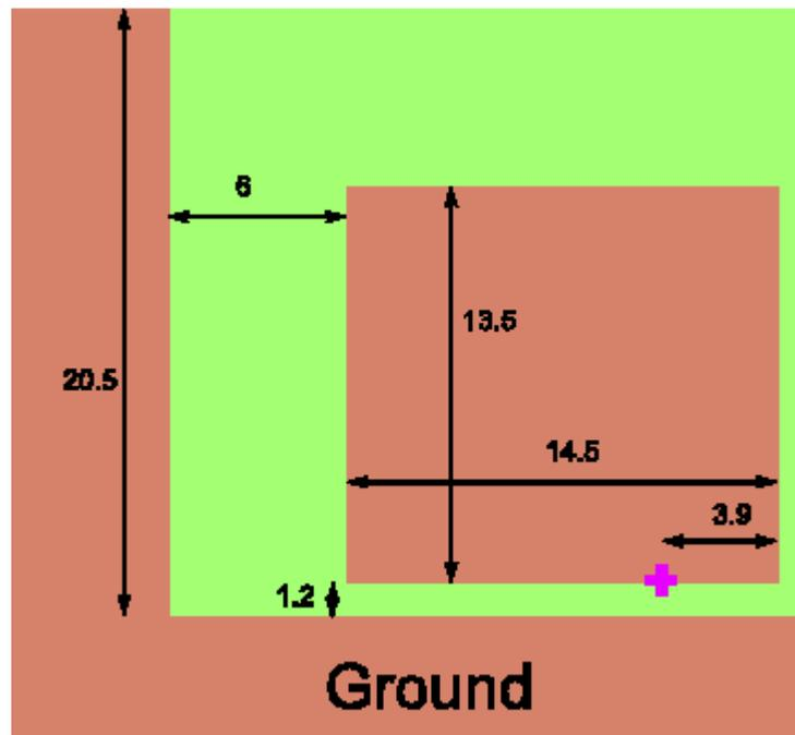
Figure 27. Patch Antenna 2
