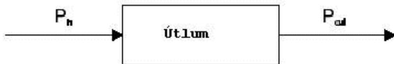
Příklad: Pokud je vstupní úroveň na přijímači poloviční, tzn., že přenosem dojde ke ztrátě poloviny energie  $P_{out}/P_{in} = 2$ , potom je útlum  $10 \times \log(2) = 3 \text{ dB}$ .
