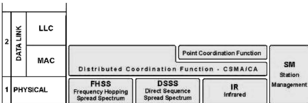
Pro fyzickou vrstvu je definován přenos pomocí infračerveného světla a rádiový přenos v rozprostřeném DSSS a FHSS spektru a to technikou přímé sekvence (DSSS, Direct Sequence Spread Spectrum) nebo technikou přeskoku kmitočtů (FHSS, Frequency Hopping Spread Spectrum). Systémy pracující infračerveným přenosem pracující v pásmu 850 – 950 nm jsou schopny pokrýt prakticky jen jednu místnost, protože pevné překážky infračervené světlo nepropouští, a z tohoto důvodu nejsou příliš zajímavé.
