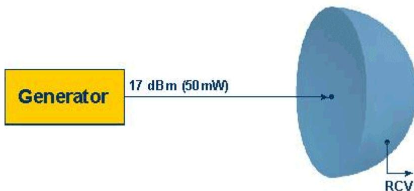
Z obrázku je zřejmé, že zisk antény úzce souvisí se **směrovostí** a následně pak s dosahem. Tato souvislost je nejlépe patrná při grafickém znázornění **vyzařovací charakteristiky** (viz obr. níže). Směrovost a vyzařovací charakteristiky antén
