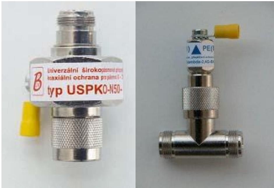
Pro potřeby Wi-Fi je jediným vyhovujícím způsobem ochrany před přepětím pásmová propust'. Pracuje na jednoduchém principu – jedná se o laděný rezonátor, který zkratuje veškeré frekvence mimo jediné pracovní, v našem případě 2,4 GHz. Kvalitní přepěťové ochrany odolají přímému zásahu blesku a jsou testovány nárazem proudové vlny o amplitudě 3 kA a době trvání 350 µs.
