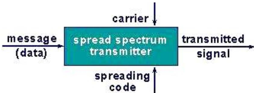
Co to znamená v praxi? Tyto systémy jsou imunní vůči interferencím generovaným jinými signály, ať toho už rozprostřenými nebo úzkopásmovými, přítomnými ve stejném frekvenčním pásmu. Také jsou obtížně zachytitelné.
