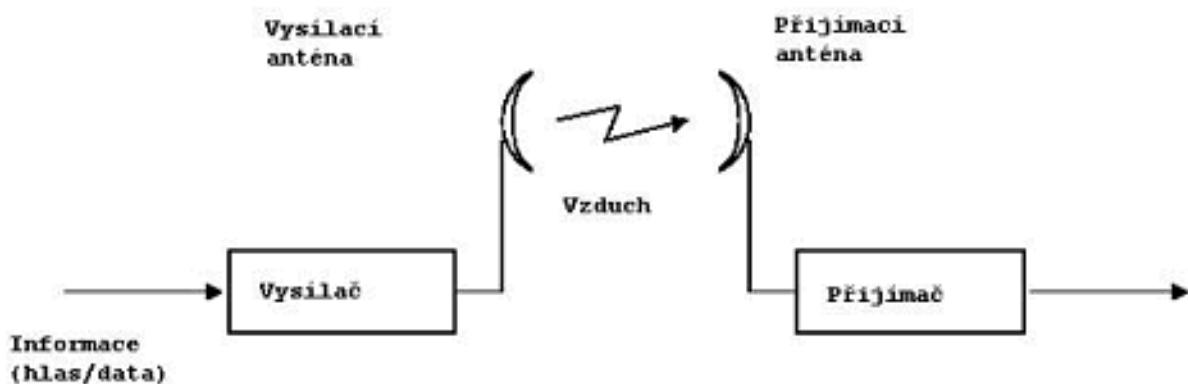
Pro libovolný výpočet je nutné znát používané jednotky a definici souvisejících parametrů. Prvním Výstupní a vstupní z nich je **výstupní úroveň vysílače** a **vstupní úroveň přijímače**. Hodnota vstupní/výstupní úrovně je vyjádřená ve Wattech případně v dBm, přičemž vztah mezi dBm a Wattu může být vyjádřen vysílače a přijímače následovně:
