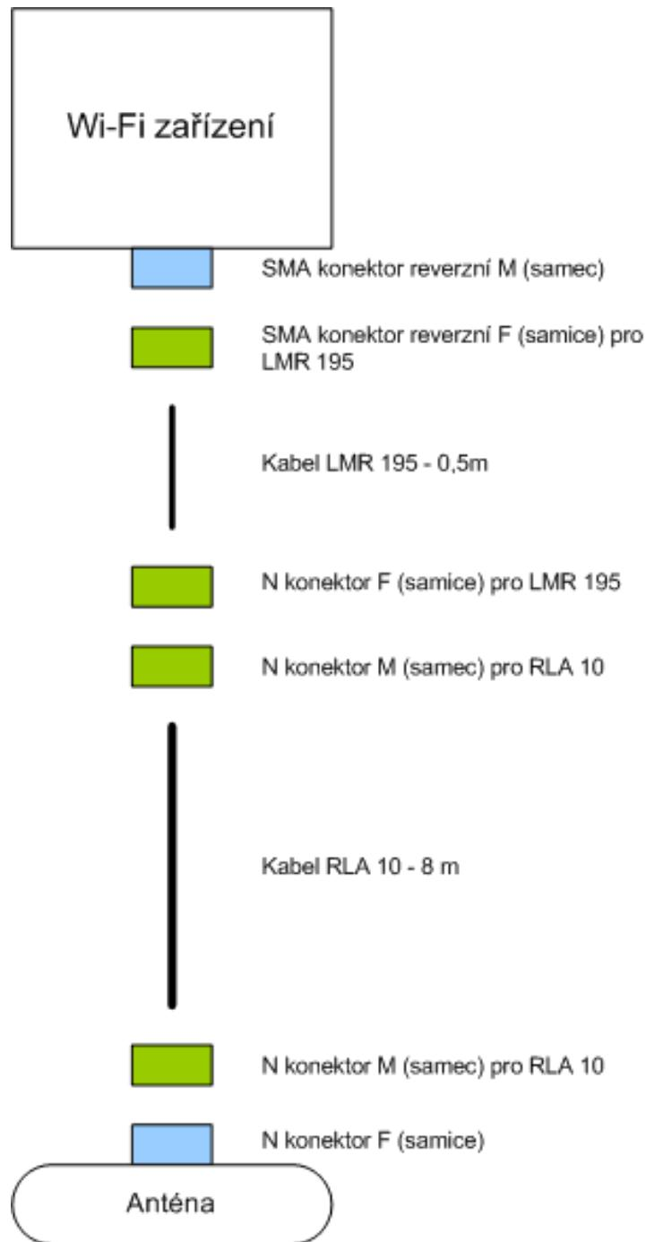
Konektory jsou krimpovací, to znamená, že je můžete pomocí speciálních kleští BNC HT(336A) jednoduše „nacvakat“ na kabel sami. Avšak doporučují se letovat.
